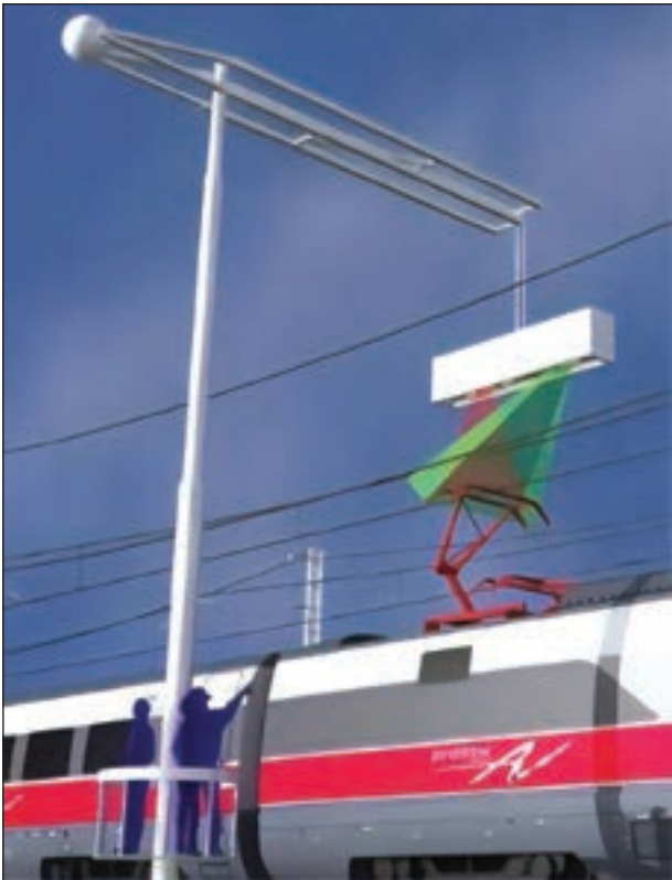
11. ábra: Eszköz felsővezeték automatikus diagnosztikához
