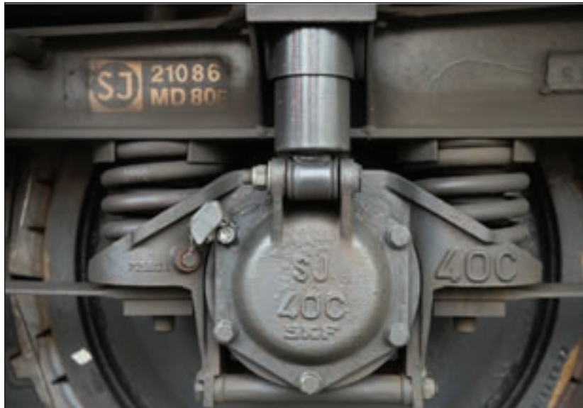
1. ábra: SKF Insight szenzorral szerelt vasúti ágytocsapágy
