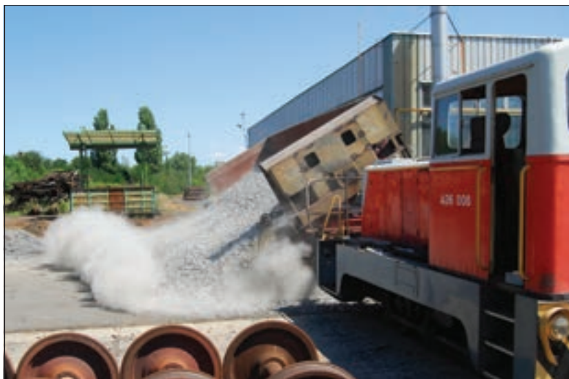
4. ábra: Billentési próba a Kárpát Vasút felújított kocsiján Abb. 4: Rekonstruierter Wagen der Karpathen-Bahn – Kipp-Prüfung Fig 4. Dumping test of the Refurbished freight wagon of Kárpát Vasút Co.
