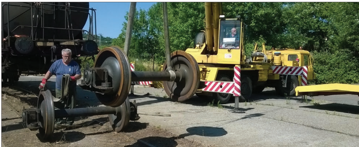
3. ábra: A Komplex Vasútépész Kft. kerékpárserét végez kisorozott teherkocsin
