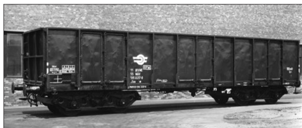
6. ábra: Kelet Európa 5 vagongyára 1967-től kezdődően 7419 db Eas sorozatú magas oldalfalú kocsit szállított a MÁV-nak
