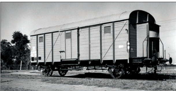
2. ábra: A MÁV a G hf (1925-től Gp) sorozatú, 7 méteres tengelytávolságú, nagy terjedelmű áruk szállítására szolgáló fedett teherkocsikat 1917-től szerezte be a Ganz és Társa Vasúti kocsigyárból.
