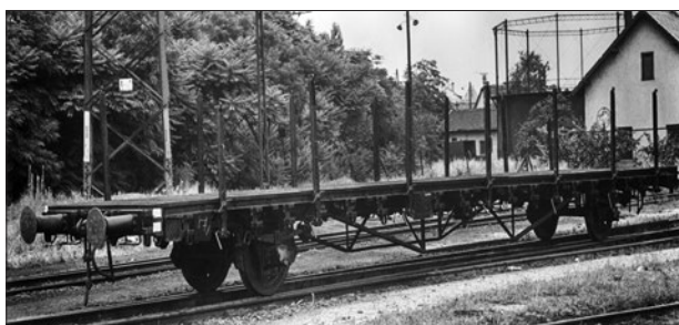
5. ábra: A Ganz-ban 1942-ben a MÁV részére fejlesztett katonai célú a 20 tonna névleges teherbírású Nzh sorozatú pórekocsi megőrzött járműve
