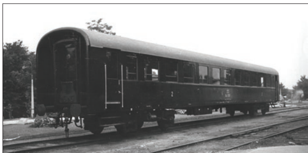
4. ábra: A MÁV 75 éve vásárolta meg a Gyzanz gyártól az első könnyűszerkezetes, 4-tengelyes, Bak és Cak sorozatú személykocsikat
