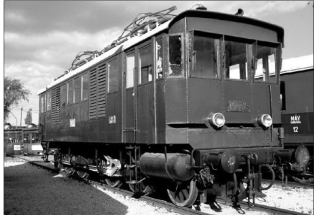
3. ábra: A MÁV V40-es Kandó-mozdony Magyar Vasúttörténeti Parkban megőrzött V40 006 pályaszámú mozdonya.
