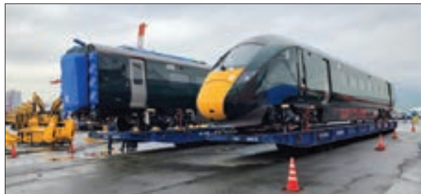
3. ábra: Hitachi AT300 villamos-dízel motorvonat
