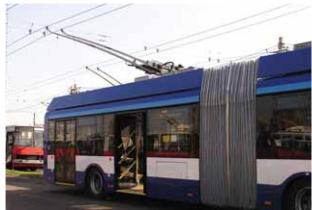
2. ábra: A pneumatikus rúdármszedő üzemben
