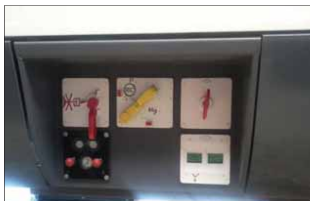
3. ábra: A fékberendezés külső kezelőszervei Abb. 3: MMBC-Schienenbremssteuerggerät – Einbau Fig 3. The operating handles of the brake system.
