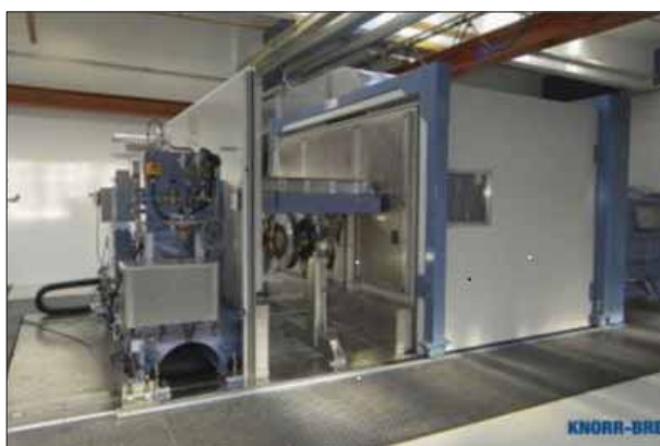
7. ábra: Dinamométeres próbapad féktárcsák és betétek vizsgálatához Abb. 7: Dynamometer-Prüfstand für die Untersuchung von Bremsscheiben und Bremssohlen Fig 7. Brake test bench for testing the brake pads.
