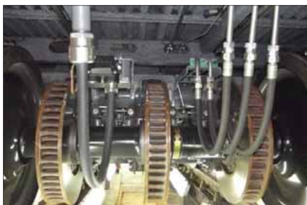
6. ábra: A biztonságos megállításhoz szükséges féktárcsák Abb. 6: Bremsscheiben für das sichere Anhalten Fig 6. The brake disks ensure the safe brake distance.
