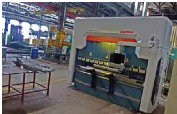
16. ábra: A lemezdaraboló és hajlító gép Fig 16: Sheet metal shearing and bending machine
