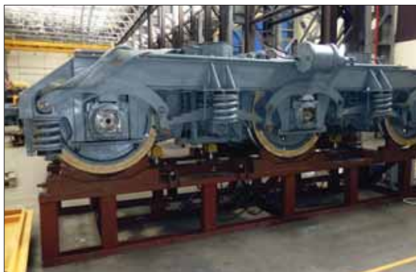
17. ábra: Forgóváz szét és összeszerelő álláshely Fig 17: Bogie disassembly and assembly station
