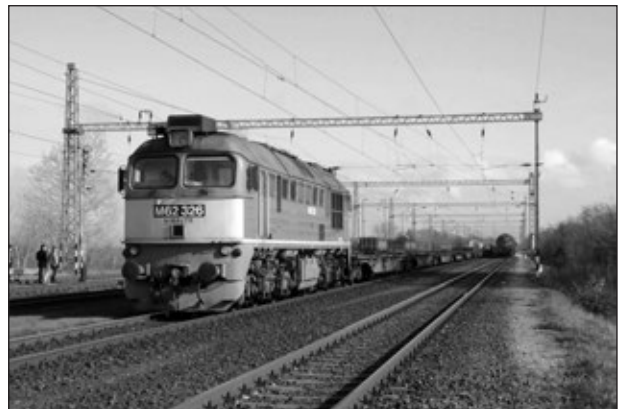
7. ábra: Az M62. sorozatú dízelmozdonyok e kutatási eredmények alapján meghozott alapjárat fordulat szám csökkentést elrendelő döntést követően közel 35 éve alatt sok ezer tonnányi gázolaj megtakarítással javították a MÁV és a GYSEV üzemgazdasági eredményét
