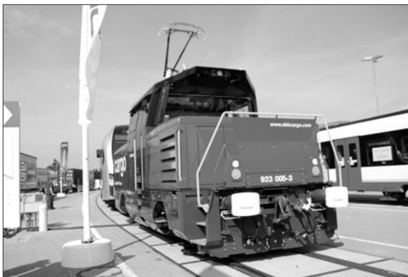
3. ábra: A 2012-es berlini InnoTrans újdonsága volt a Stadler által gyártott, Ee 923 sorozatú dízel-villamos kettős erőforrású mozdony, amelyből az SBB sorozatot rendelt
