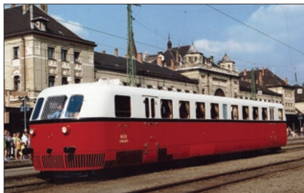
2. ábra: Ganz-Jendrassik dízelmotorral gyártott Árpád típusú motorkocsi Abb. 2.: Arpad hergestellt Jendrassik Ganz Dieseltriebswagen-Typen Figg. 2.: Arpad produced Jendrassik Ganz diesel railcar types
