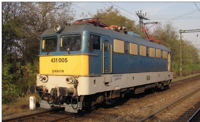
1. ábra: A képen látható V43-ast Németországban 51 éve gyártották. Ez a mozdony a Szlovákiába közlekedés engedélyezése céljából közel 50 évesen korszerű éberségi és vonatbefolyásoló berendezéssel lett ellátva
