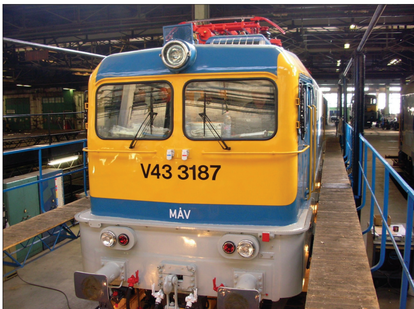
8. ábra A német vezérlőkocsik járművezérlőkhöz az Északi Járműjavító Kft.-ben átalakított 3000-es sorozatú V43-as
