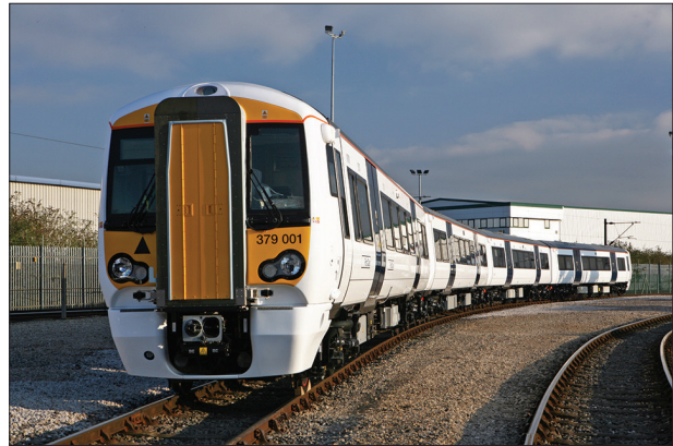
8. ábra A Bombardier 379. sorozatú villamos-akkumulátoros motorvonata
