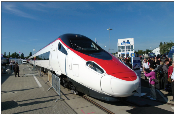
1. ábra Az Alstom ETR 610 billenőszekrényes motorvonata
