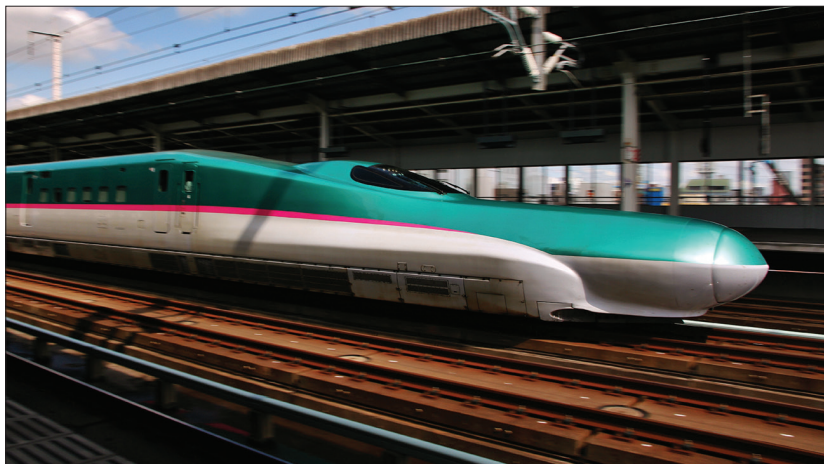
4. ábra Az E5 sorozatú motorvonat nyíl alakú orr kialakítással épült vezérlőkocsija
