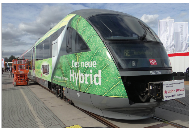
9. ábra: A DB Desiro-H villamos erőátviteli energiavisszatáplálásra képes hibrid motorkocsi
