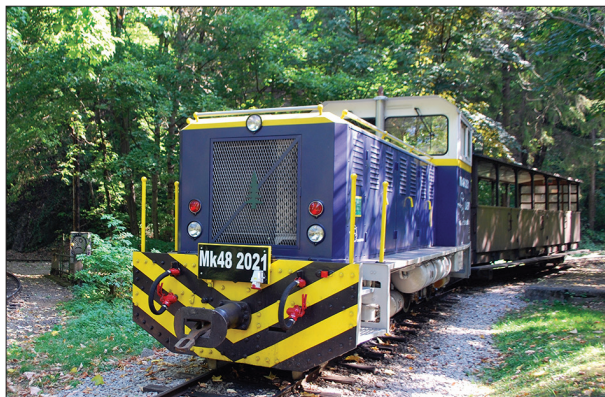
13. ábra: A lillafüredi volt a világelső hibrid keskeny nyomközű mozdony, amely magyar mérnökök tudását hirdeti
