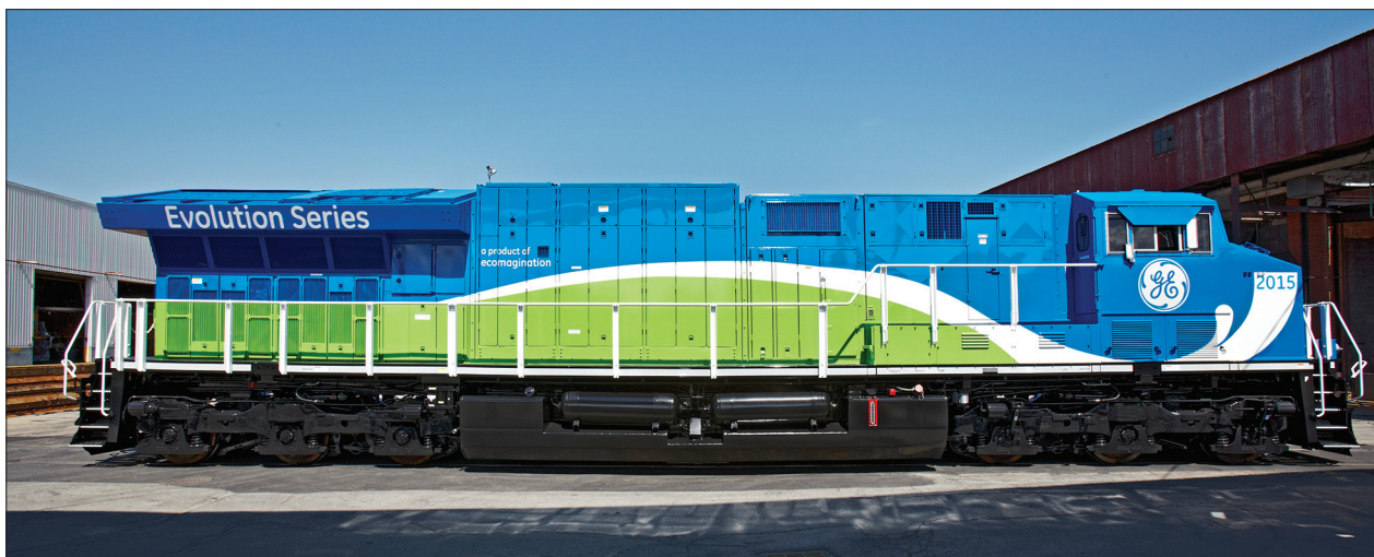
11. ábra: Az amerikai olcsó olaj világában is fontos a hibrid fejlesztés az egyre szigorodó kibocsájtási előírásoknak köszönhetően. Ez a mozdony már képes teljesíteni az Amerikában 2015-ben életbe lépő károsanyag kibocsájtási követelményeket. A 12 hengeres, 4400 lóerős mozdony szennyező részecske kibocsájtása 70%-al alacsonyabb, valamint nitrogén-oxidból is 76%-al kevésbé terheli a környezetet, mint az alapmozdony
