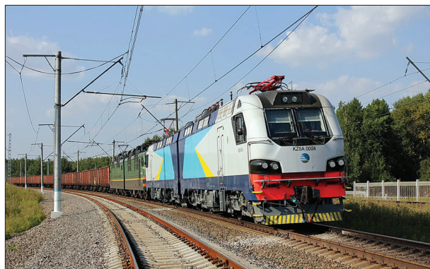
4. ábra: Alstom 8,8 MW teljesítményű villamos mozdony
