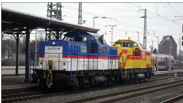
1. ábra: A 2006-os a berlini Innotrans világkiállításon bemutatott német V100-ból fejlesztett Alstom hibrid mozdony, immár üzemben
