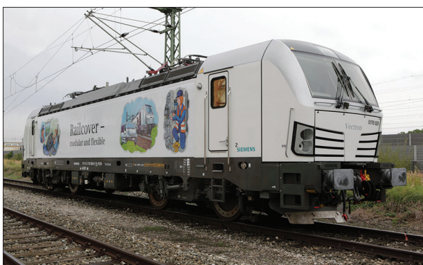
5. ábra: A Siemens Last Mile Vectron kettős erőforrású villamos mozdonya is megoldás a felsővezeték nélküli vonalszakaszokon közlekedésre
