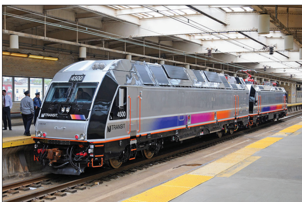
3. ábra: A Bombardier ALP-45DP 2010-ben mutatkozott be. A típus egyaránt képes üzemelni 12,5 kV 60 Hz AC, 12 kV 25 Hz AC, 25 kV 60 Hz AC feszültségekről, továbbá 2 db Caterpillar 3512C HD típusú dízelmotorja segítségével bármilyen nem villamosított vonalon
