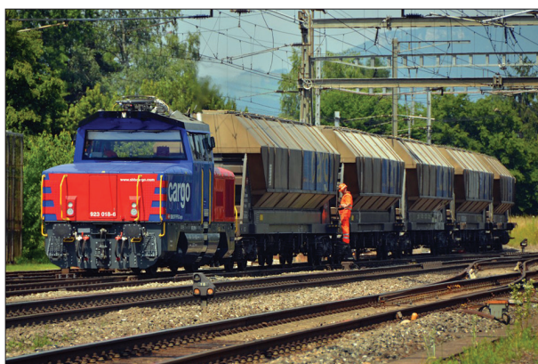
4. ábra: A napjainkban már 30 járműves a Stadler gyártmányú SBB Eem923 hibrid flottája. A mozdony 15 kV 16,7 Hz AC/25 kV 50 Hz AC feszültségekről képes üzemelni (max. 1,5 MW) és el van látva 290 kW-os dízelhajtással is
