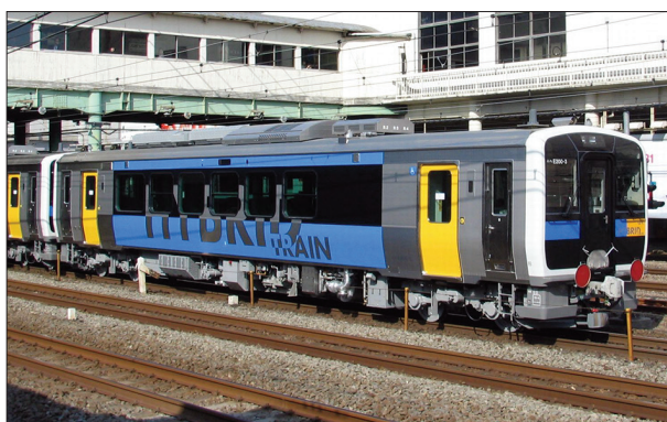
6. ábra: A japánok fontosnak tartják a nem villamosított vonalrészeken a gyors áthaladást, ezért új hibrid motorkocsikat fejlesztettek ki és állítottak közforgalomba
