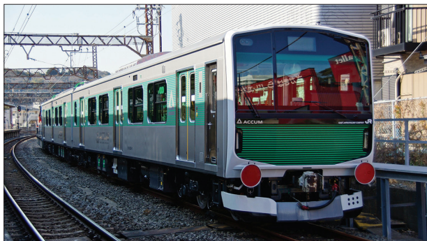
7. ábra: A fotón a japánok legújabb hibridmotorvonata az EV-E301 A DC 1500 V-os felsővezetéki hálózat alatt közlekedő motorkocsi a felsővezeték nélküli vágányokon is tud közlekedni a beépített 190 kWh vontatási akkumulátor telepei segítségével, amelyekkel akár 65 km/h-s sebességet is el tud érni. A közforgalomban üzemeltetett motorvonatot lapunk idei első számában mutattuk be
