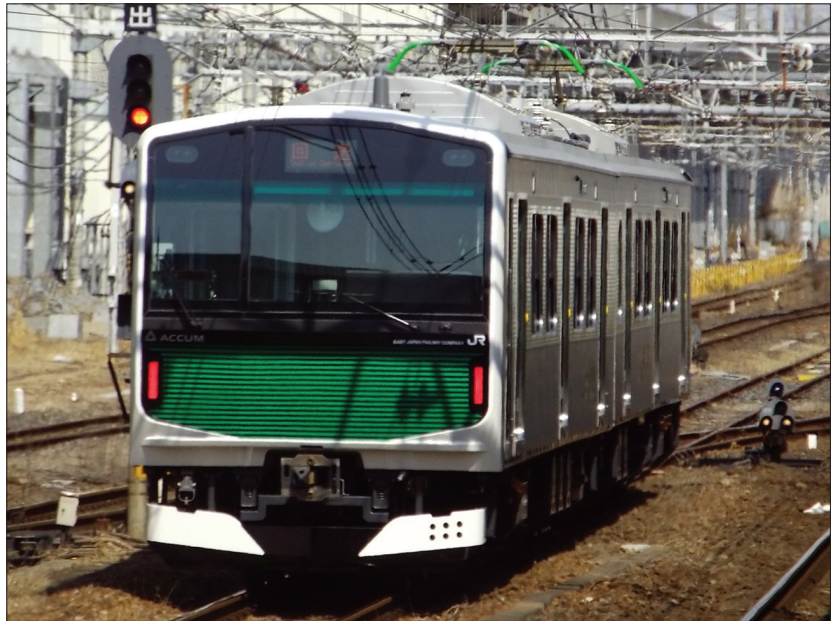
24. ábra A legújabb japán akkumulátoros villamos motorvonat azonosítója az EV-E301
