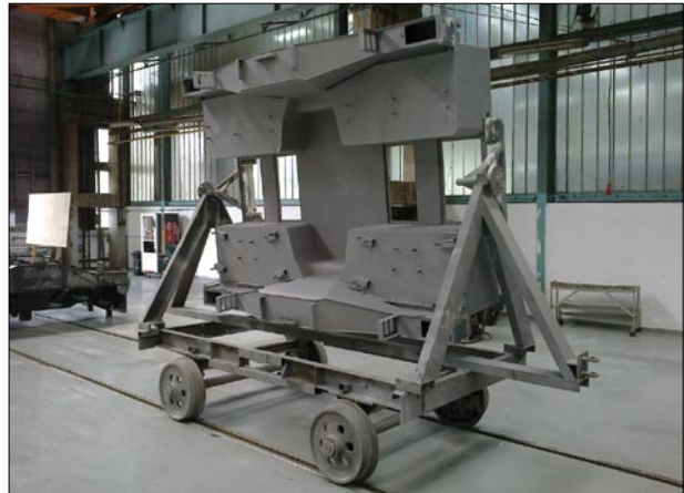
3. ábra Festésre váró brüsszeli villamos alváz
