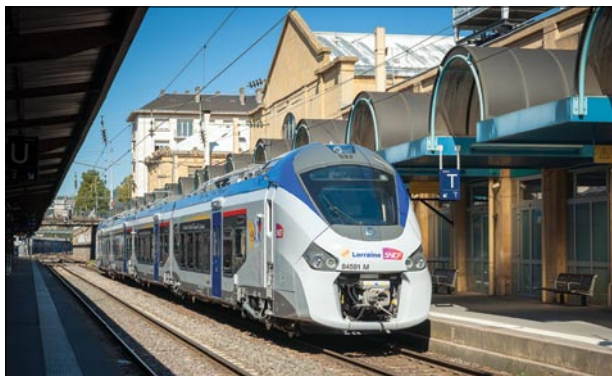
13. ábra Az Alstom által a francia Lorraine régióba szállított Régiolis két erőforrású motorvonat
