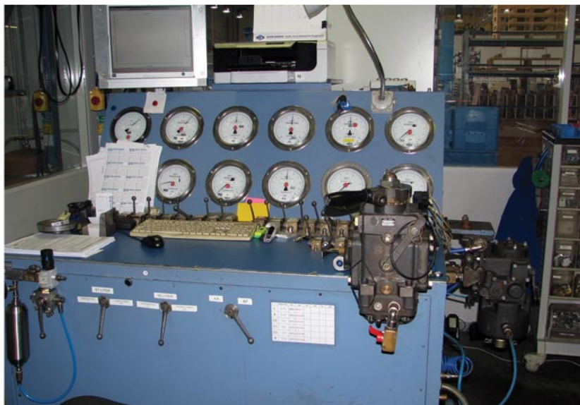
2. ábra MÁV Vagon Kft. részére felújított KE1 típusú kormány szelep próbapadi vizsgálata
