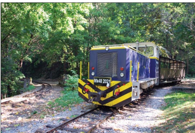
1. ábra A világelső keskeny nyomközű dízel-hibrid mozdony
