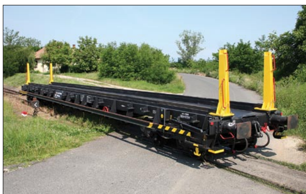
19. ábra A MÁV Vasjármű Kft. 2006-2007 években szlovák megrendelésre 21 db Rgs kocsiból jelentős innovációs munkával, Slps típusú, vasúti pályaépítésben használatos járművet fejlesztett ki és gyártott le Szombathelyen. A kocsik új német tulajdonosának elégedettségét igazolja, hogy mintegy 1000 km-s távolságból, az esedékes fővizsgákat a gyártónál rendelte meg. Tehát a kocsik visszatértek Szombathelyre, hogy a járműjavítóban elvégezzék a tervszerű karbantartásokat
