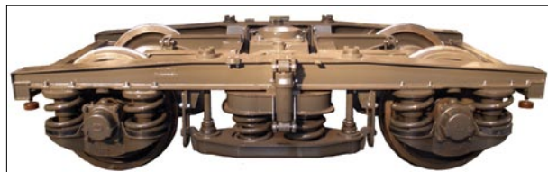
4. ábra Tárcsafékessé átalakított Görlitz V forgóváz Forrás: Bombardier MÁV Kft.
