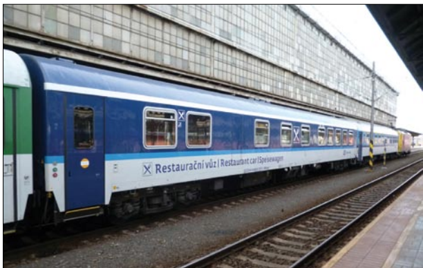
5. ábra A WRmee CZ-ČD 61 54 88-81 017-2 pályaszámú étkezőkocsi – alatta a GV/Dk 005/2011 és a GV/Dk 006/2011 forgóvázak – a prágai főpályaudvaron
