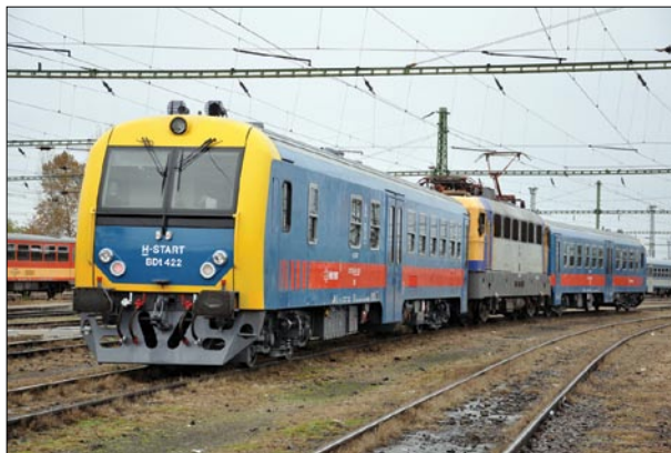
2. ábra V43-as vezérlőkocsis vontatásra átalakítva vezérlőkocsi próbán
