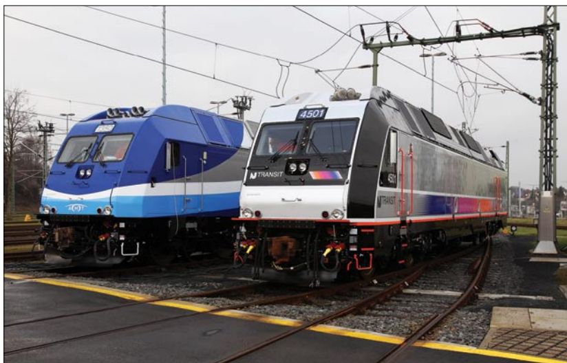
12. ábra A Bombardier ALP nagy teljesítményű kettős erőforrású mozdony Abbildung 12. Hochleistungs-Zweikraftlokomotive Typ Alp von Bombardier Figure 12. The Bombardier ALP, high performance and dual powered loco
