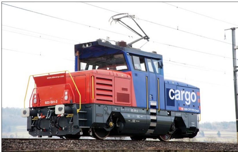
11. ábra A Stadler Ee 923 kettős erőforrású tolatómozdonyokat az SBB Cargo üzemelteti Abbildung 11. Zweikraft-Rangierlokomotive Typ Ee 923 von Stadler - Betreiber: SBB Cargo Figure 11. Stadler Ee 923 dual powered shunting locos operated by SBB Cargo
