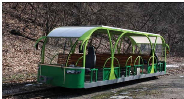
18. ábra Királyréti kisvasút akkumulátoros-napelemes motorkocsija
