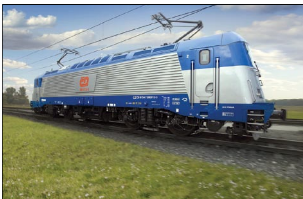
4. ábra Škoda 109e 6,4 MW-os villamosmozdony
