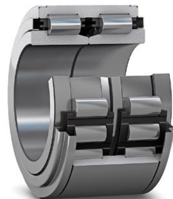
3b. ábra Műanyag kosárral és labirinttömítéssel szerelt hengergörgős csapágyegység
