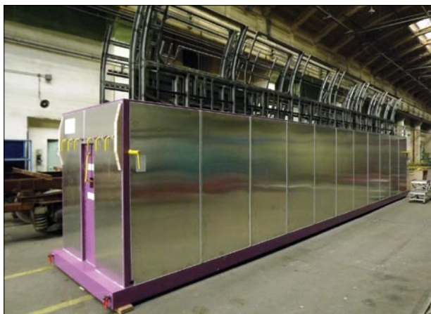
Az első NDW oldalfalváz szállítókalodában a saját gyártású szállítókalodában (Fotó: Bombardier MÁV Kft.)
