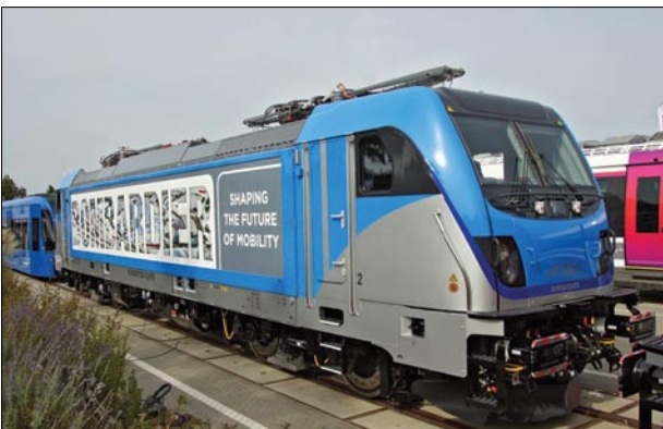
8. ábra TRAXX AC a Bombardier kettős erőforrássú villamos/dízel mozdony (Fotó: Bombardier)
