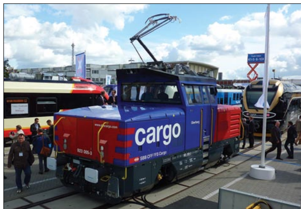
6. ábra A Stadler gyártmányú Ee923 villamos-dízel hibrid tolatómozdony
