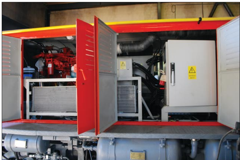
3. ábra Megnövelt kapacitású akkumulátort rejtő tároló szekrény a géptérben található
