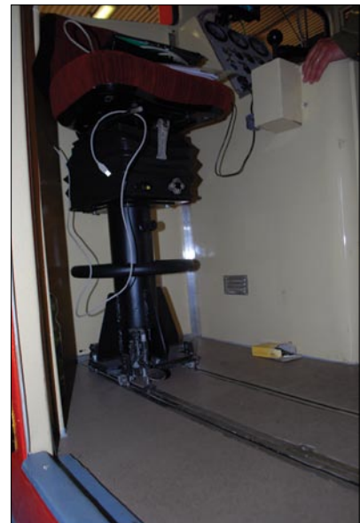
5. ábra Ötletes, menetirányváltáshoz igazítható vezetőülés növeli a mozdonyvezető kényelmét
