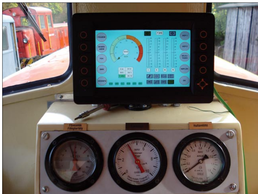
4. ábra A megújult vezetőasztal színes kijelzős fedélzeti számítógéppel lett felszerelve Abbildung 4. Der erneuerte Fahrerpult – ausgerüstet mit Bordrechner und Farbdisplay
