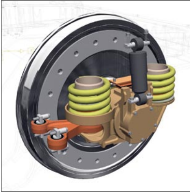
3. ábra Kerékpár csapágy háromszög-lengőkarral Abbildung 3. Radsatzlager mit Dreieck-Lenker Figure 3. Wheel set bearing with triangle trailing arm
