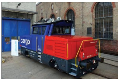
3. ábra Elkészült az Ee 922 testvére. Már üzembe helyezték a Stadler Eem 923 sorozatú hibridüzemű tolatómozdonyát az SBB Cargo megrendelésére
