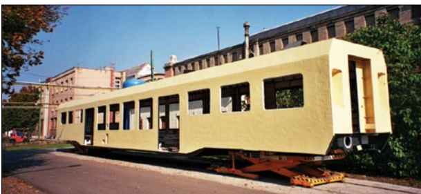
11. ábra Az elsőként elkészült INOVA kocsiszekrények egyike Dunakeszin
