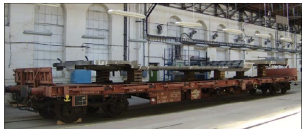
6. ábra Szállításra előkészített Regio Express alváz Dunakeszin (Fotó: Bombardier MÁV Kft.)
