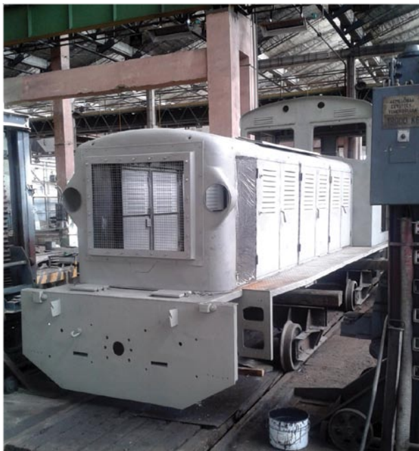
1. ábra Szombathelyen kettős erőforrásúra átalakítás alatt az Mk48 403
