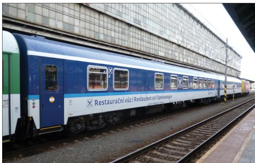
3. ábra A Görlitz V forgóváz egy cseh kocsi alá beépítve
