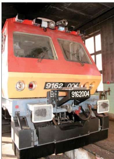
A MÁV Központi Felépítésvizsgáló Kft. tulajdonában lévő 99 55 9162 004-3 (volt FMK-004) pályaszámú jármű egy „téli karbantartás” jellegű javítás keretében kapott új diagnosztikai berendezést a szombathelyi MÁV Vasjármű Kft.-ben. A diagnosztikai berendezések villamos szerelését, beállítását olasz szakemberek végezték. Ezen kiegészítéssel a jármű alkalmassá válik Magyarország teljes vasúthálózatának a vizsgálatára – ürszelvény szempontból is.
