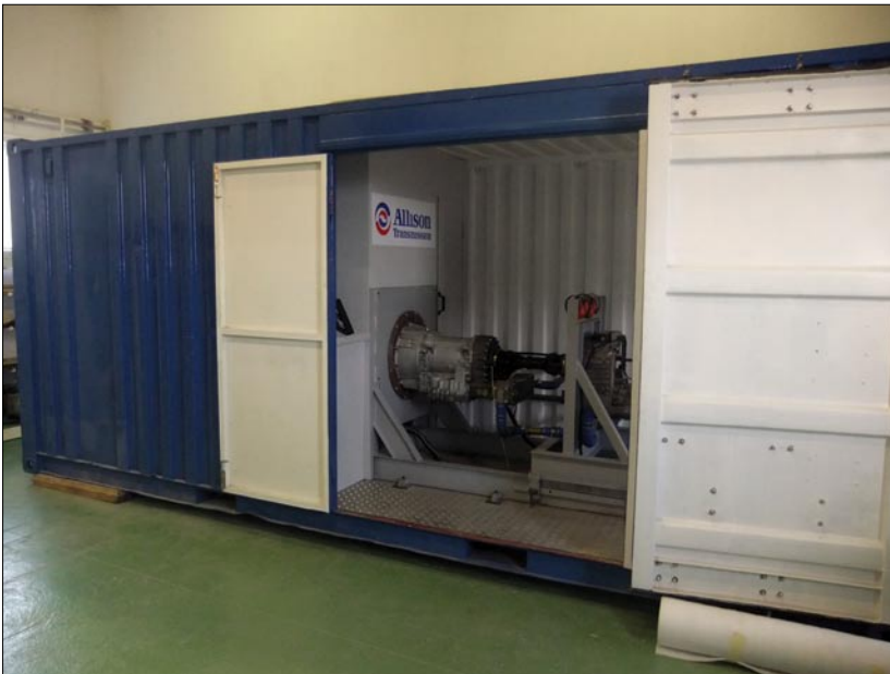
1. ábra Mobil nyomatékváltó próbapad
