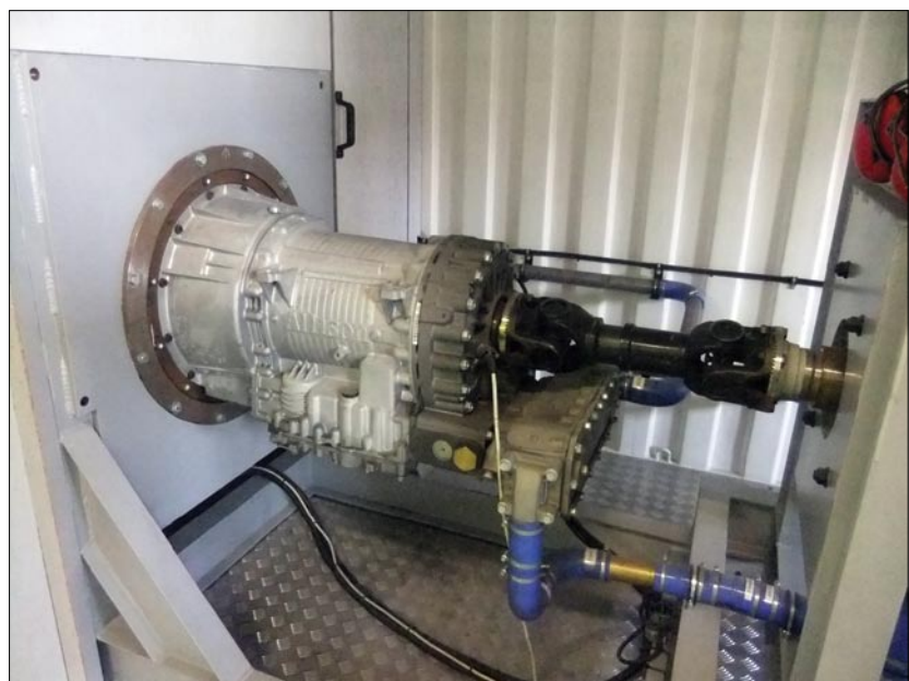
2. ábra Nyomatékváltó tesztelése
