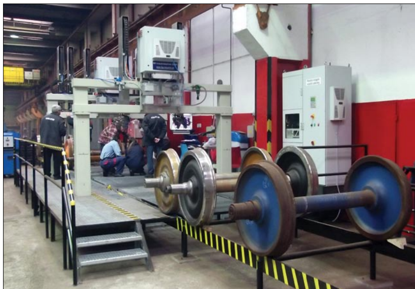
3. ábra A tengelyvizsgálatra 32 vizsgálófejes berendezés lett telepítve
