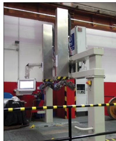
2. ábra A kerékpár diagnosztikai rendszer 16 vizsgálófejes, ebből 8 örvényáramú
