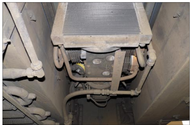
13. ábra Knorr VV180-T típusú olajmentes légsűrítő a BDVmot 008 motorkocsiban
