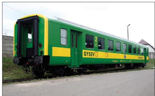
2. ábra A GySEV Schlieren-gyártmányú kocsit a MÁV Vasjármű Kft. a megrendelő színtervnek megfelelően festette át és végezte el a járművek fővizsgáját
