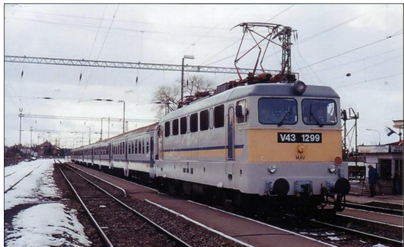
3. ábra Az újrávillamosított vonalon a V43-as mozdony vontatta Bh szerelvényekkel indult a villamos vontatás
