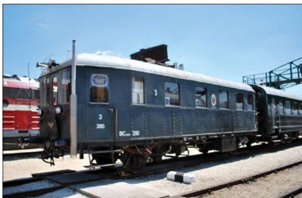
6. ábra Az ABmot eredetileg benzinmotoros volt Abbildung 6. Der ABmot-Triebwagen war ursprünglich mit Benzinmotor ausgerüstet
