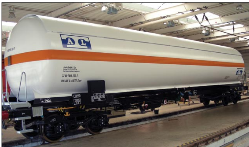
5. ábra Y25Lsd1-K típusú forgóváz a 120 m 3 Zagns sor. nagynyomású gázzszállító kocsik alatt Abbildung 5. 120 m 3 Hochdruck-Gastransportwagen – Zagns – mit Y25Lsd1-K-Drehgestellen Figure 5. The 120 m 3 Zagns high pressure tanker with Y25Lsd1-K type bogie
