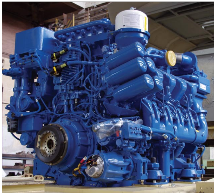
2. ábra Az M47 1327–1334 pályaszámú mozdonyokba beépített dízelmotor, Szombathely 2010.08.18.
