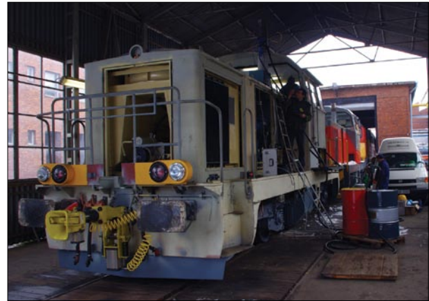
8. ábra Az M47 1331 pályaszámú mozdony mérése, a mozdony mellett a gázelemző műszereket szállító mérőkocsi, Szombathely 2010.11.30.
