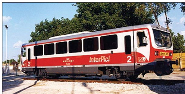
3. ábra A klimatizált utasterű InterPici motorkocsi
