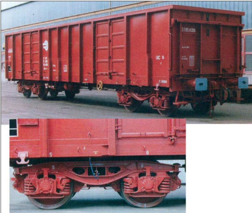
3. ábra Y 25 Cs típusú forgóváz az Eas-x sor kocsai alatt Abbildung 3. Eas-x Wagen mit Y 25 Cs-Drehgestellen Figure 3. The Eas-x coach with Y 25 Cs type bogie
