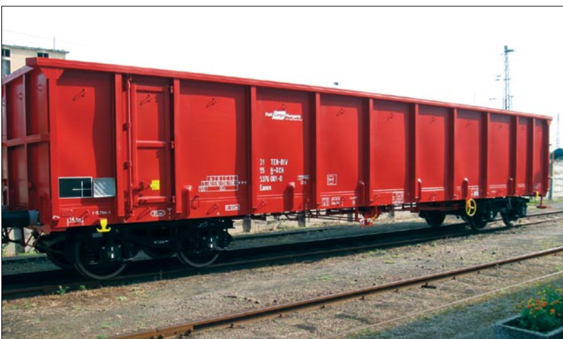
4. ábra Y 25 Lsd-K típusú forgóváz az Eanos sor. kocsai alatt Abbildung 4. Eanos-Wagen mit Y 25 Lsd-K-Drehgestellen Figure 4. The Eanos coach with Y 25 Lsd-K type bogie
