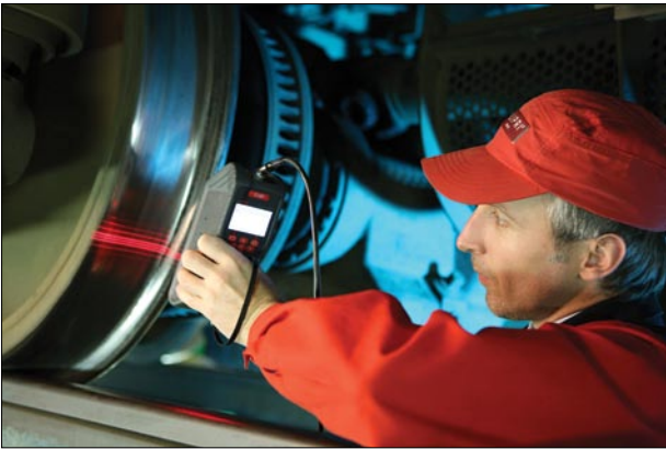
8. ábra Lézeres kerék profilvizsgáló berendezés (mérőkapta)
