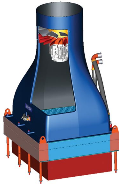
12. ábra Alacsony zajszintű hűtőberendezés a Voith-tól
