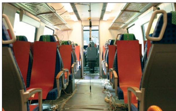
4. ábra Utastér klíma komfortvizsgáló berendezés
