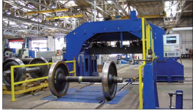
10. ábra Telepített kerékpár vizsgáló berendezés
