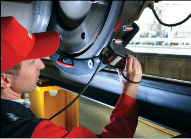
7. ábra Kerék futófélület vizsgáló berendezés
