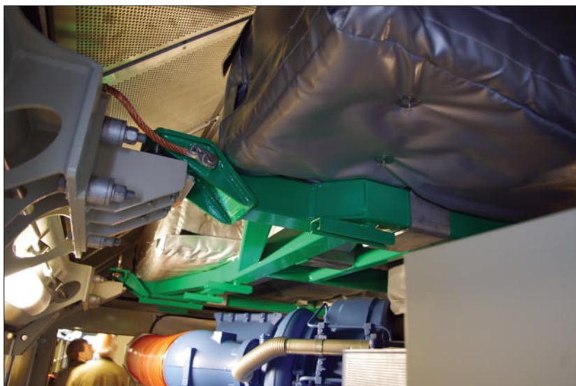
10. ábra A károsanyag kibocsátást csökkentő szűrő berendezés a Vectron-DE-ben a dízelmotor felett elhelyezve
