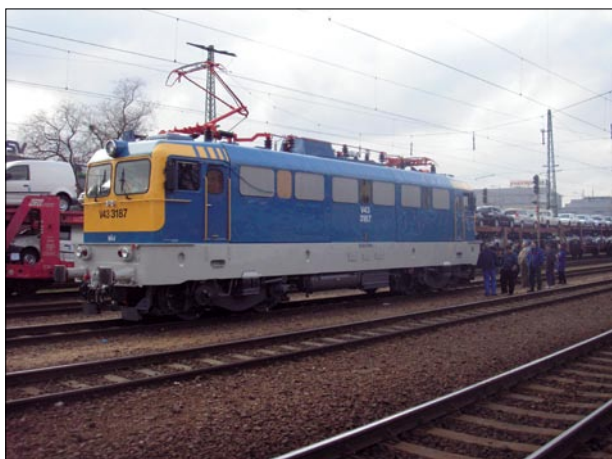
11. ábra/Abb. 11./Fig. 11. A V43 3000 sorozat kialakítását a használt német vezérlőkocsikkal való együttműködés igénye hozta létre
