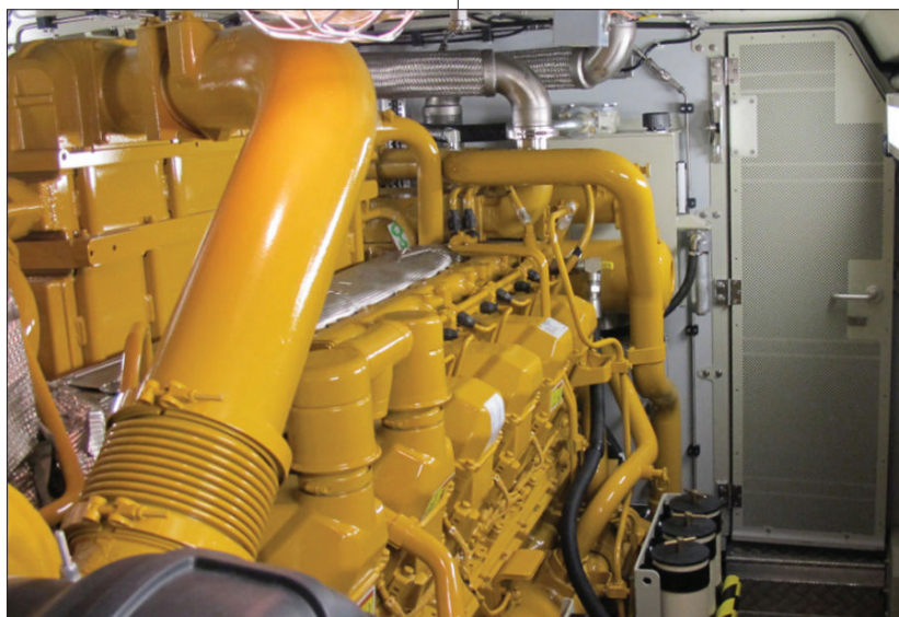
A Bombardier ALP-45DP típusú, kettős erőforrású, 2 dízelmotoros mozdony egyik Caterpillar dízelmotorja
