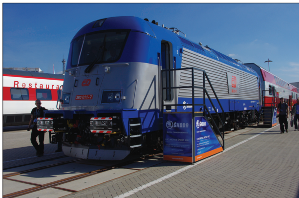
12. ábra A Skoda 6400 kW teljesítményű villamos mozdonya is 200 km/h sebességgel továbbíthat vonatokat (Fotó: Kovács Károly)
