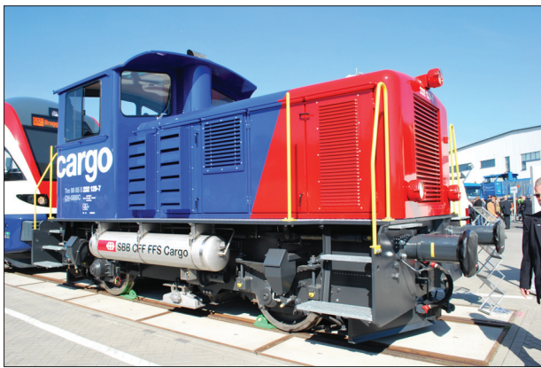
17. ábra Stadler gyártotta 232 sorozatú mozdony az SBB részére, A kiállított mozdony kettős erőforrású változata Svájcban készül (Fotó: Kovács Károly)
