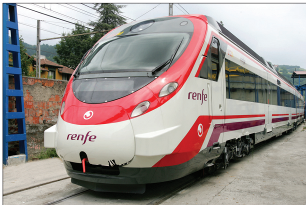
5. ábra Renfe megrendelésére gyártott CAF Civity villamos motorvonat (Fotó: CAF)
