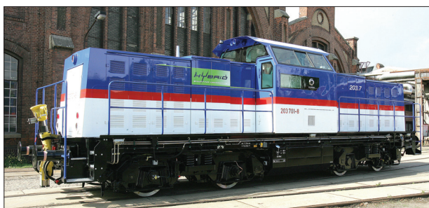
14. ábra Az Alstom 203 sorozatú hibrid rendszerű tolatómozdonya (Fotó: Alstom)
