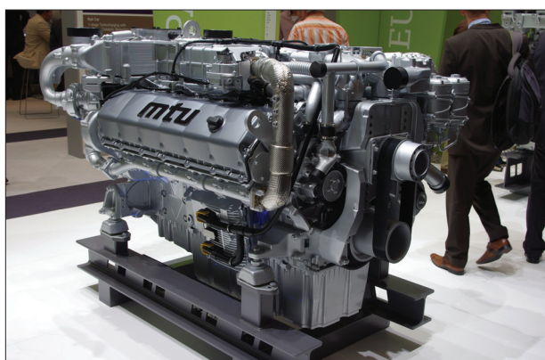
22. ábra Az MTU dízelmotorja (Fotó: Horváth András)
