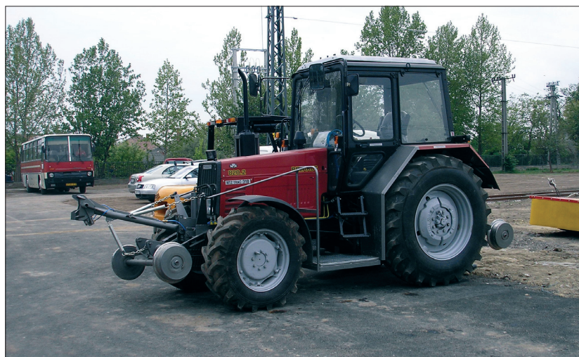
15. ábra A karbantartóvágányon a jármű mozgatót ún. lokotráktor végzi
