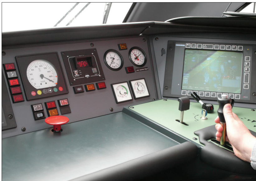
19. ábra Magyarországon a FLIRT hatósági járművizsgáján a közforgalomban megengedett 160 km/h sebesség felett +10%-al kell tudni megbízhatóan üzemelni
