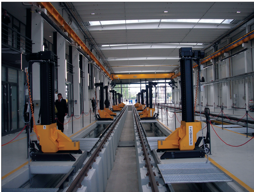
16. ábra A karbantartó csarnoki álláshelyeken az egész motorvonat megemelhető
